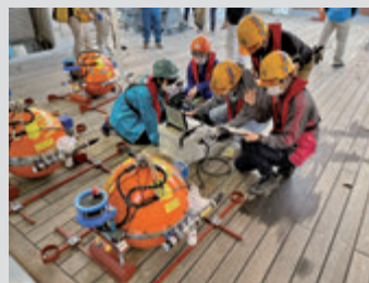
海底地震計の投入準備
