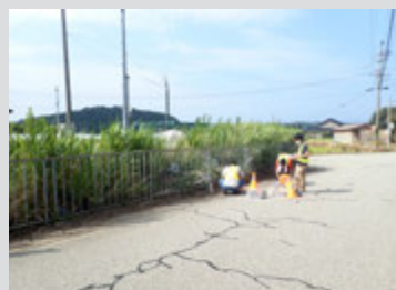
2023年5月5日能登半島の地震(M6.5)で震度6強を観測したK-NET正院(珠洲市)での地盤構造調査
