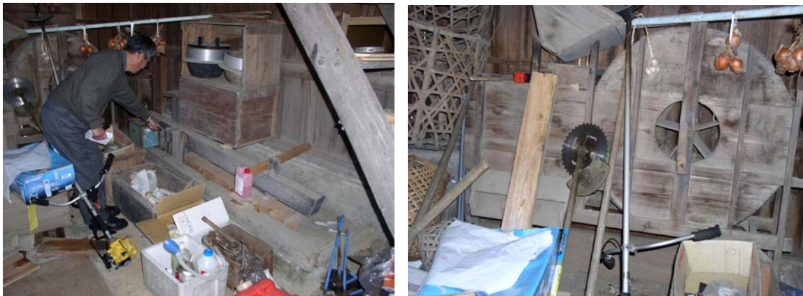
写真3 唐臼（左の写真）と唐箕（右の写真）。松實氏が指し示す部分が唐臼の竿の支点。亀本氏の話にあったように、もしもこの竿がはずれるとすれば、地震の縦揺れで10cm 余り跳ね上がらなくてはならない。
