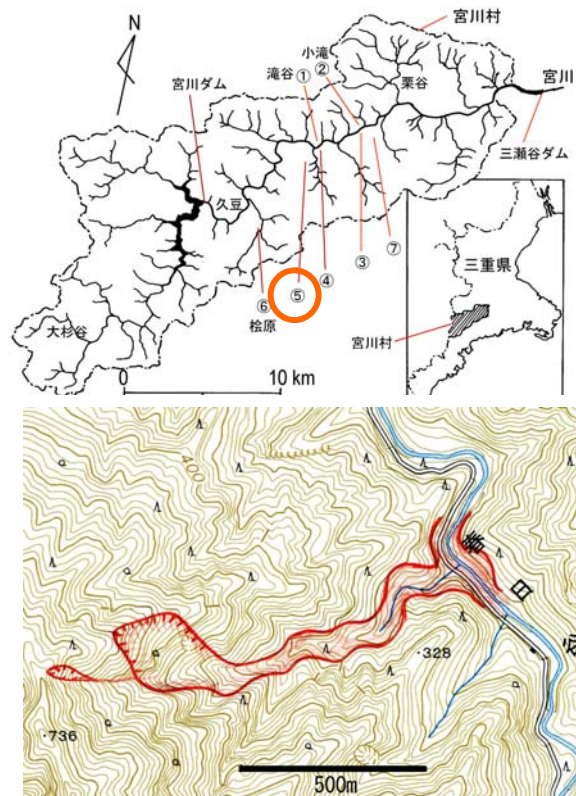
図 8 春日谷左支谷の崩壊と岩屑なだれ流下範囲。国土地理院 1/2.5 万間弓図幅を改変
