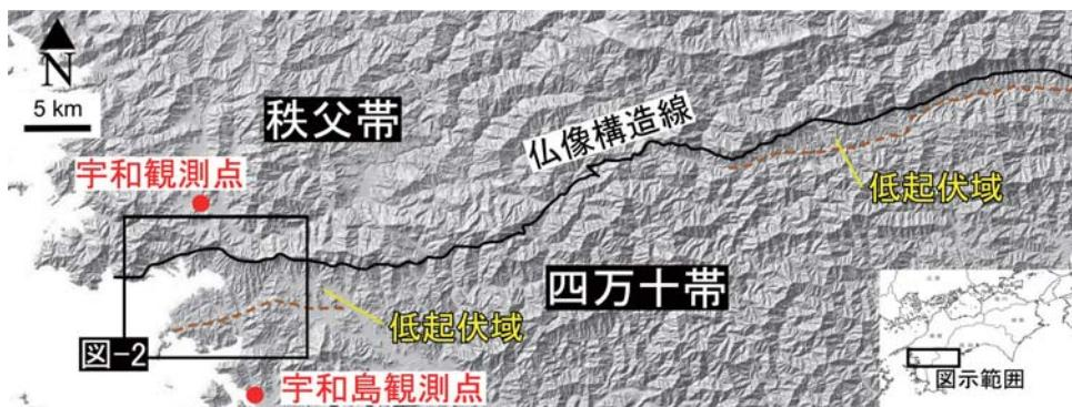
図-1 調査範囲、気象観測点の位置および四国南西部の仮想構造線周辺における地質と地形
