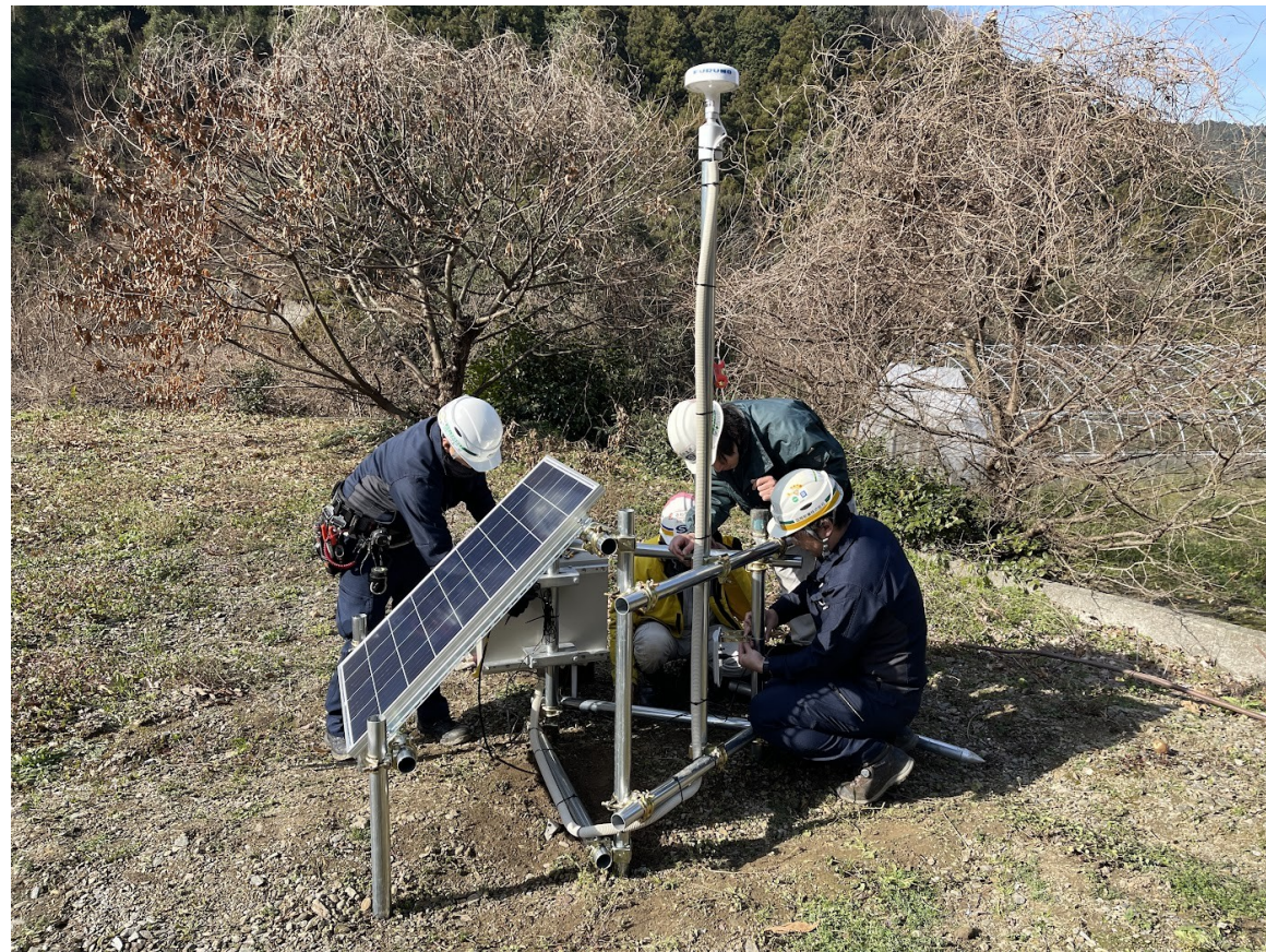
GNSS観測（センチメートル級精度）
