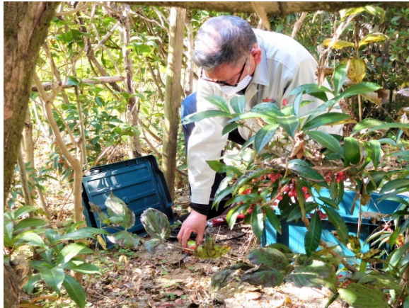
上下動地震計を土に差し込む
