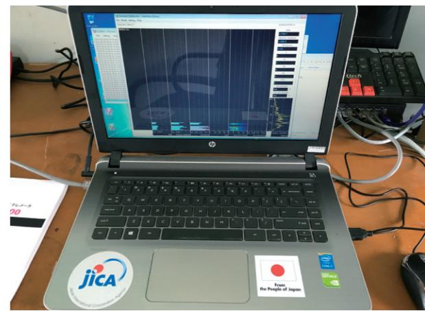
図1-2 マグマ噴出率を即時に算出し表示するシステム。火山観測所のパソコンにて稼働しています
