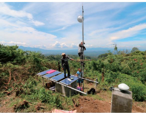
図1-1 ガルンゴン火山の観測点設置風景。右手前にGNSSアンテナ、中央にWiFiアンテナがあります。太陽電池とバッテリーを電源としています。データはWiFiにて常に火山観測所に伝送されています
