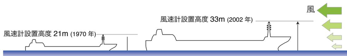
図1 船舶大型化に伴う風速計設置高度が見かけ上の風速増加を引き起こす。
