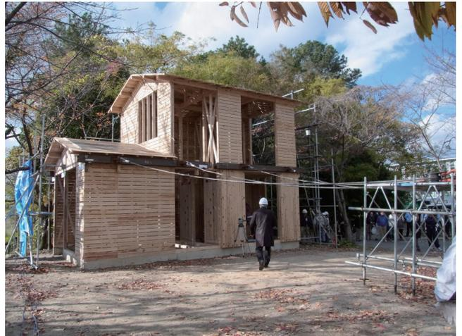
写真1 壁柱工法で補強した実大試験体
