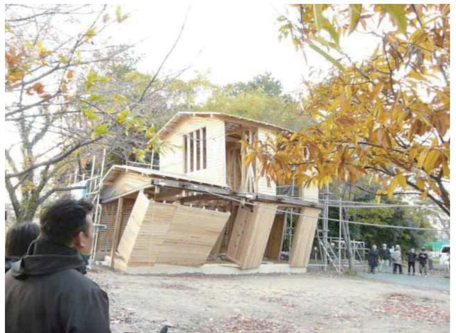
写真2 補強試験体の倒壊直前の状況
