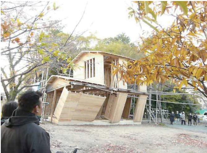
補強試験体の倒壊直前の状況 (4P)
