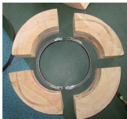
図3 補強のため分割された柱
