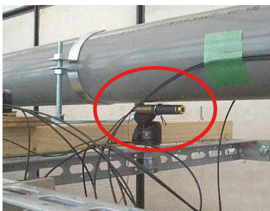
写真2 砲身下部に取り付けられたレーザーポインタ
