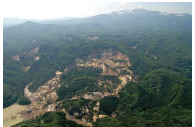
写真1 荒砥沢ダム貯水池上流の大規模岩盤地すべり。末端部は、手前の尾根に衝突した後、向きを変えて、貯水池に流入した(撮影:王功輝)
