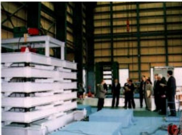
写真1 建物模型を用いたアクティブ制震実験
