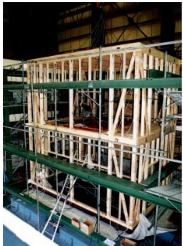
写真2 2階建木造住宅の実大実験
