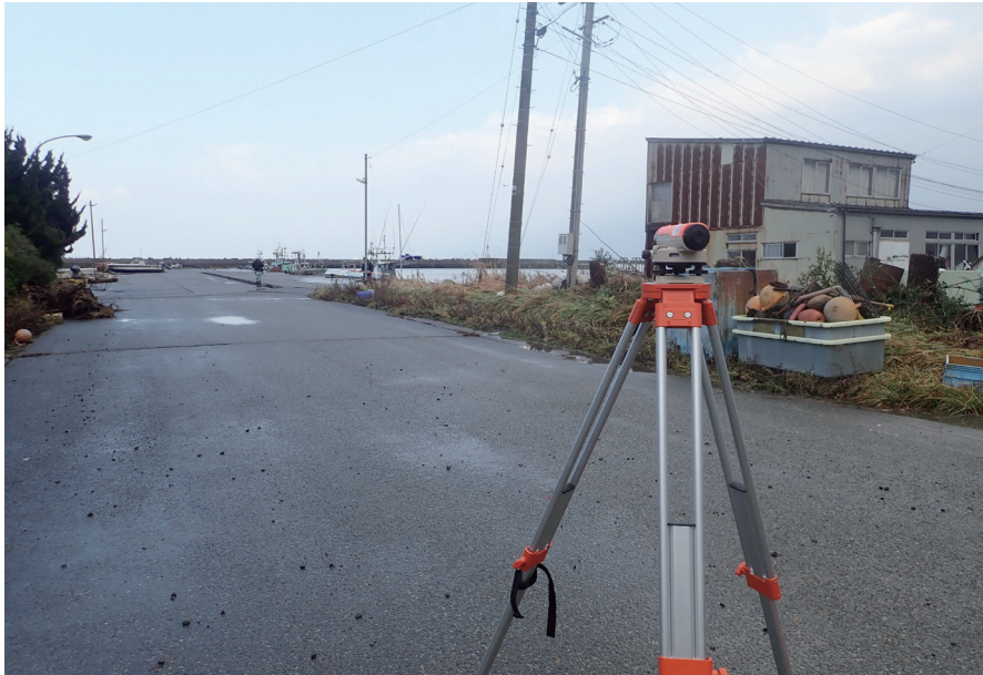
図1 津波痕跡高の測定の一例。海面から痕跡までの高さを水準測量によって測り、その時の天文潮位をもとに高さの補正を行います。
