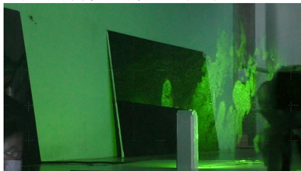
図 3. レーザーシートで可視化した加熱された建物模型後流の流れ
