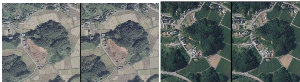
図-3 1976年撮影 切土はほぼ終了 東側から植栽 図-4 2019年山形沖地震後斜面の滑落が見られる
