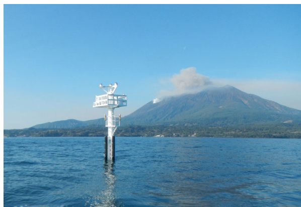
海底地盤変動観測装置
