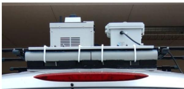
マイクロ波放射計（左）と雲カメラ（右）。移動中の公用車直上の大気中に含まれる水蒸気量の高さ分布、雲の水平分布を連続的に観測する
