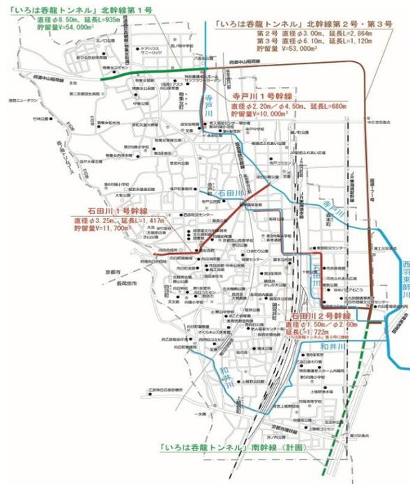
Fig.3 雨水地下貯留施設地図
