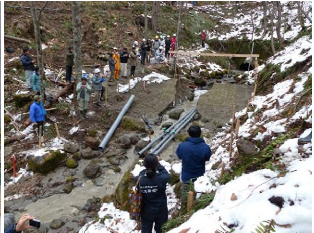
写真2 天然ダム決壊実験の様子
