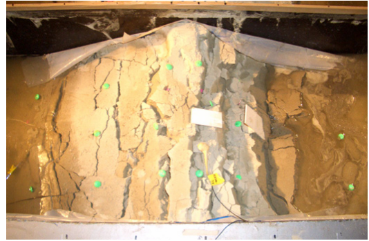
写真 盛土が不飽和状態の最終性状
