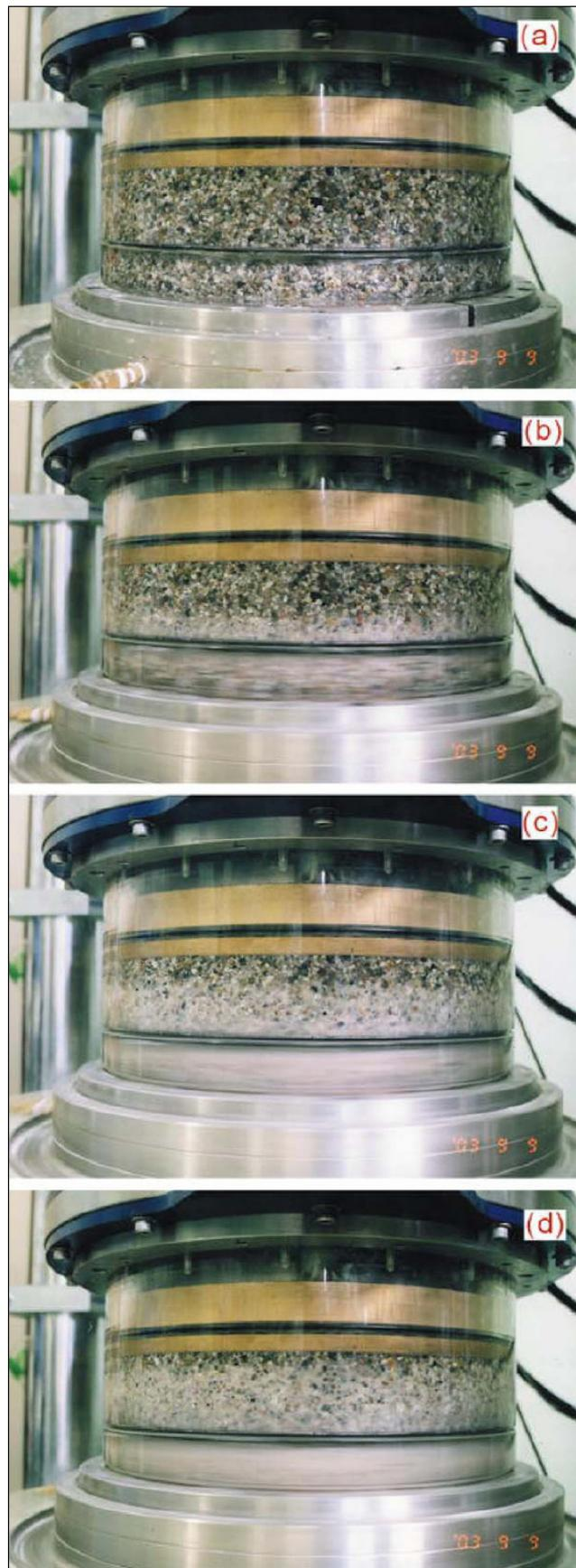
図10 可視型試験機におけるせん断中のせん断ゾーンにおける粒子破砕の進行
