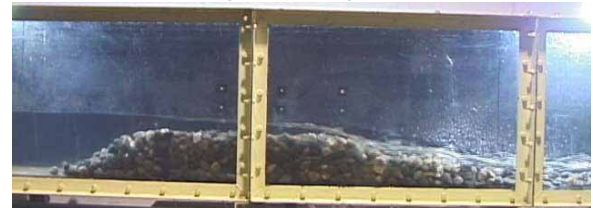
(d) 4th stage (discharge: 28.7 l/s)
