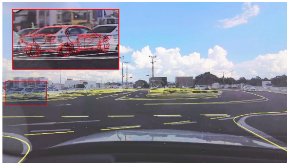
図 2. 推定したカメラ位置・姿勢から見た CG 映像と歪み補正済み被害映像の重ね合わせ (赤枠は被害車両付近の拡大) ([2] の図を改変)
