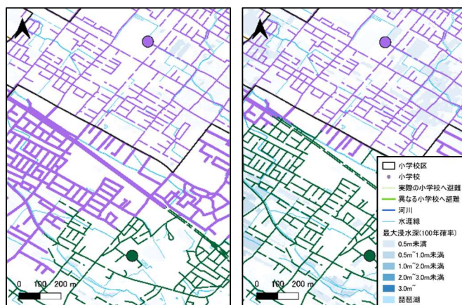
図 1. リスクを考慮したネットワークボロノイ分割の結果(左:10 年確率, 右:100 年確率)
