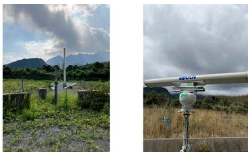
図1 黒神観測室の船舶レーダ RHI (左) PPI (仰角 25^{\circ} + 5^{\circ} 右)
