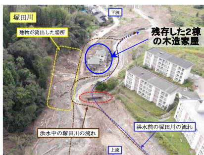
図 1 2024 年奥能登豪雨の塚田川の氾濫で被災した輪島市久手川町堂山地区 D (左)。2 棟の古い木造家屋は残存しており、上流側の RC 造の塀により流失を逃れていた (右)。
