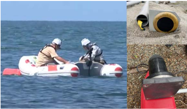
図2 湖上調査作業と音響センサー
