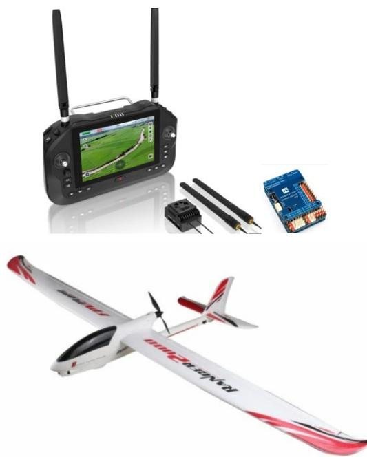
図3 市販の安価なシステムによって構築した画像伝送固定翼ドローンシステム
