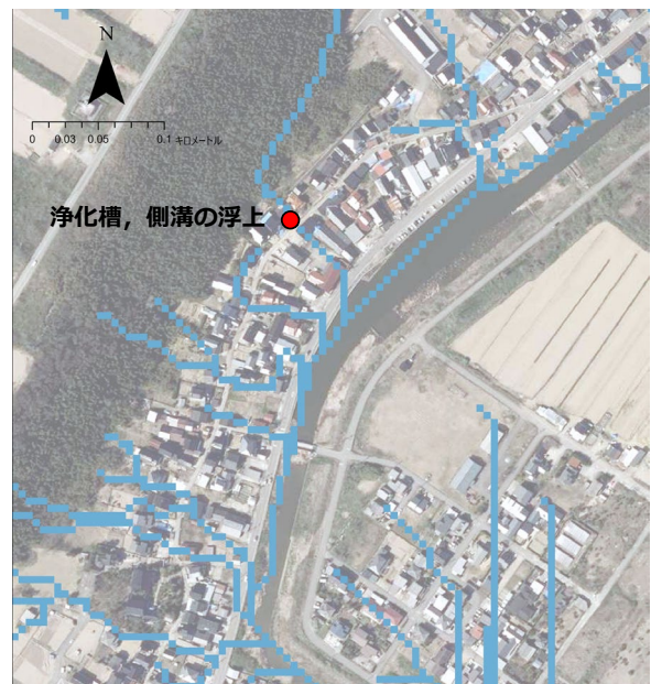
図 3 推定流路と地中埋設物浮上の被害地点 (地理院地図に加筆)
