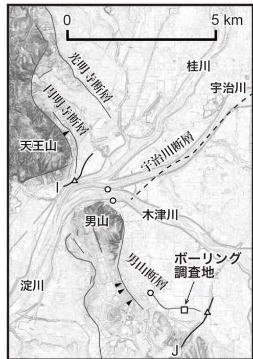
図1 調査地域の地形・活断層と調査地点の位置。基図は地理院地図。△は柱状断面図で認定された活断層の位置を、○は既存の物理探査で認定されている男山断層の位置を示す。
