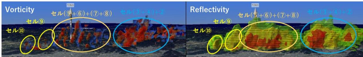
図2 渦度(左)と反射強度(右)の三次元描画結果 (亀岡豪雨, 2012年7月15日02時00分) 左は赤が正の渦度で, 青が負の渦度を表す。
