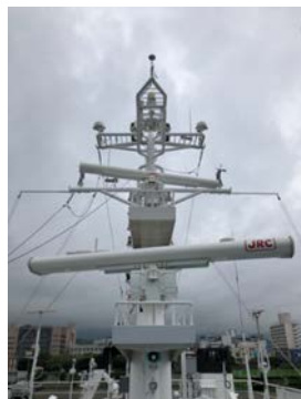
図1 かごしま丸レーダアンテナ X-band(上) S-band(下)
