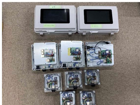
Fig.3: 製作中の簡易震度計。上段は、7 インチディスプレイを持ち、常駐者がいる施設に設置予定の機材、中段はディスプレイを持たず、無人施設に設置予定の機材、下段は MEMS 加速度計センサを収めた振動検出部分。
