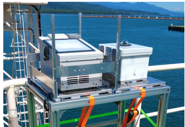
図1. 新青丸コンパスデッキに設置したマイクロ波放射計（左）と全天雲カメラ（右）。
