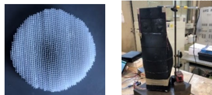
図6 整流グリッドおよび送風洞
