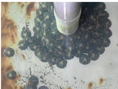
図-5 径6m円柱構造物での被災状況
