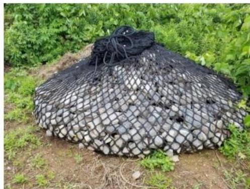
図-2 8t 型 フィルターユニットの外観
