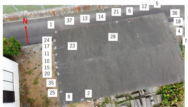
図 3. 圧力計測位置 (赤色防水キャップの位置)
