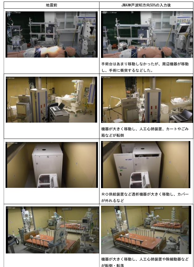
図4 試験体内部の様子（JMA神戸50%加振後）
