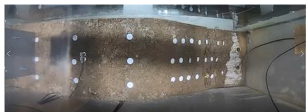
図-6. 振幅2.5倍の地震波の入力前, 入力後の上面からの画像
