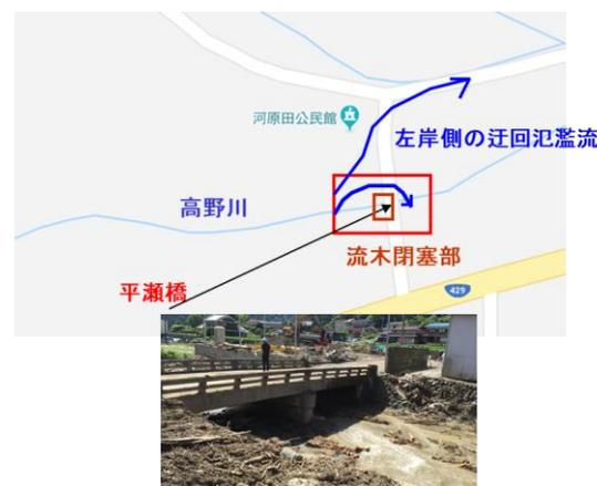
図-1 橋梁での流木閉塞と迂回氾濫流の発生
