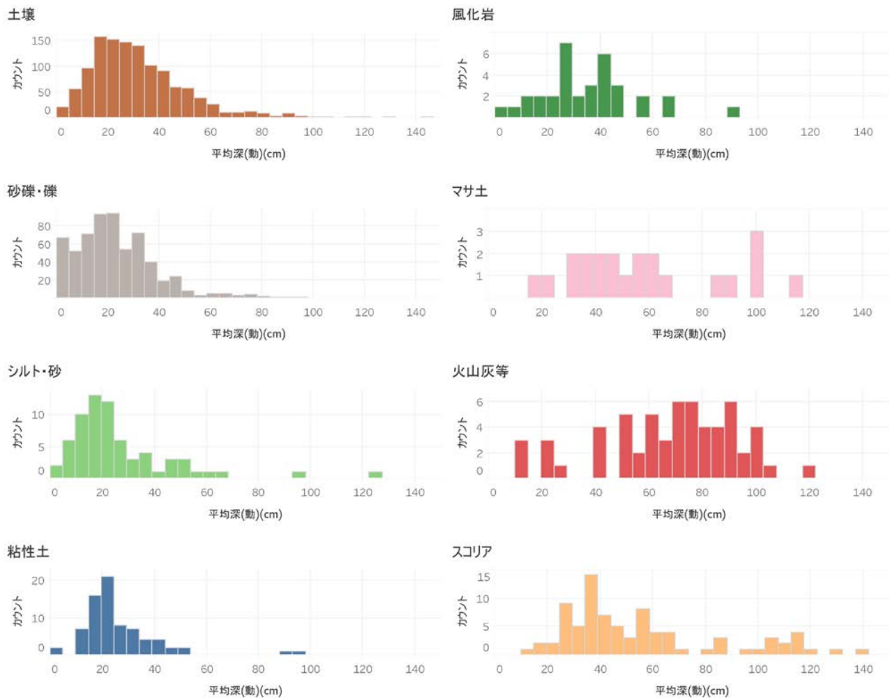
図-1 道路災害対策調査報告書の斜面調査表 (昭和 54 年度~57 年度、国土地理院) に記載された検土杖深 (平均深 (動))
