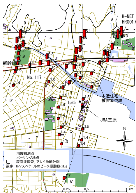
図 1 木造住宅の構造被害分布と H/V スペクトルのピーク振動数
