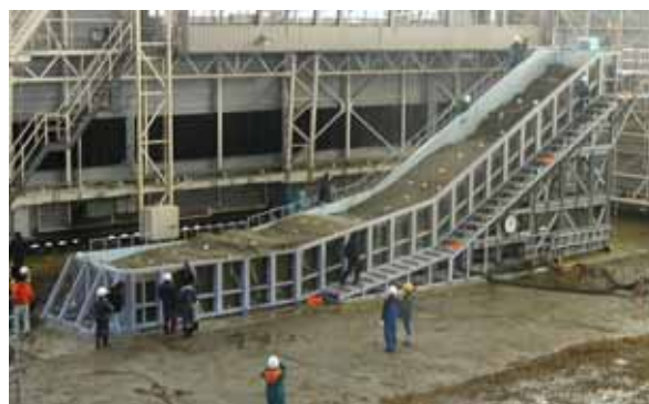
写真-1 崩壊後の大型模型斜面 10度斜面から水平部土層にかけて圧縮ひだが見られる。
