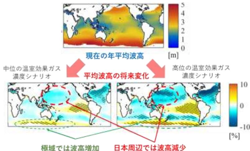
図2：波浪（平均的な波高）の将来予測結果。 斜線は予測確度が高い海域を表している
