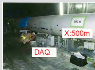
重力波望遠鏡KAGRAの安定動作のために併設された長基線レーザー歪計のデータ収録装置 Data acquisition system for the laser strain meter attached to the gravitational wave telescope KAGRA.
