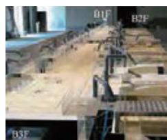
地下空間浸水実験装置
