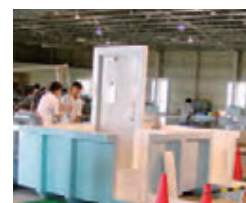
浸水体験実験装置 (ドア模型)
