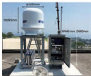
火山噴煙検知のためのXバンドMPレーダー X-band MP radar to detect volcanic ash cloud
