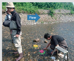
土砂移動計測器と 乱流計測器の設置
