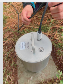
地震計の設置の様子
