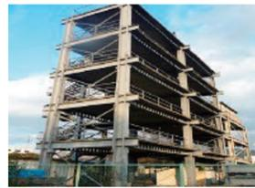
A-3鋼構造実大試験架構
