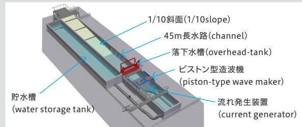
津波・高潮・高波再現水槽。長さ45m、水槽部分の幅4m、水槽の深さ2m
