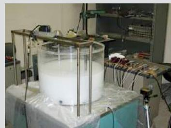
地震時に発生する液面揺動の制御デバイスの開発
