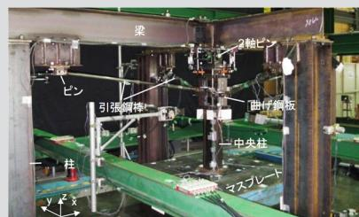
当分野で開発した低負荷耐震補強機構の動的2軸載荷実験
