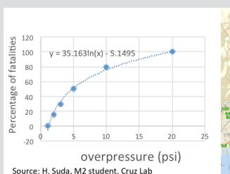
LPGガス爆発事故の圧力に起因した死亡確率
