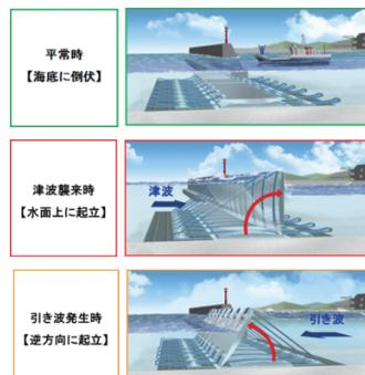
津波防災のための可動型流起式防波堤の開発に向けた産官学の共同研究
