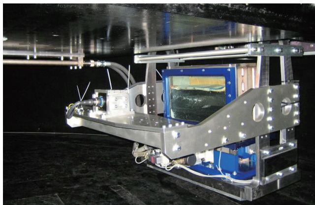
土槽搭載時の遠心力載荷装置
