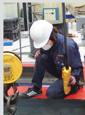
遠心模型実験に供する試験体の設置風景。
