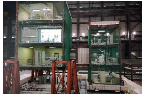
大型振動台実験による災害時重要施設の機能損失や事業継続性の評価
