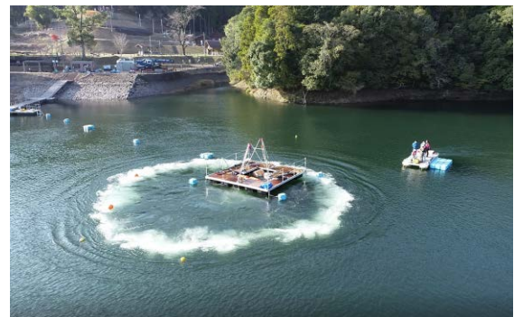
長期連続反射法地震探査基礎実験（令和2年度）におけるエアガン発振（始良市住吉池）
