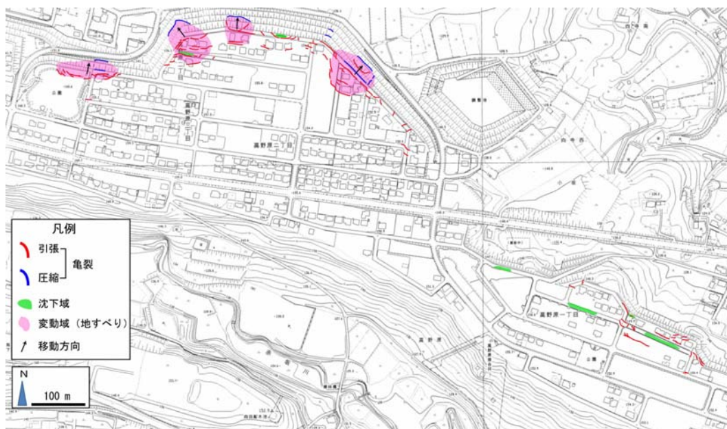
図-10 高野原北側斜面における地表変動
