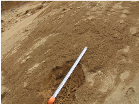
押野の崩壊源に見られたすべり面
